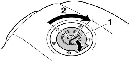
1. Cache-serrure du bouchon de réservoir de carburant
