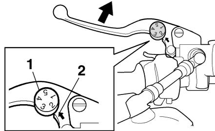
1. Molette de réglage de position du levier d'embrayage
