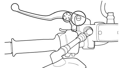
Contrôler le fonctionnement des leviers de frein et d'embrayage avant chaque départ et lubrifier les articulations de levier quand nécessaire.
