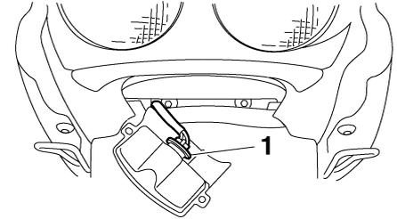
1. Douille d'ampoule d'éclairage de la plaque d'immatriculation
